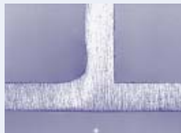
図3 T形隅肉接合断面 (ステンレス、0.5mm)
