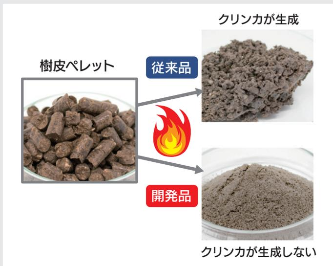
工業技術センターが取り組んだ一連の基礎実験の結果をもとに、清本鐵工株式会社と株式会社フォレストエナジー門川は実証試験を行いました。樹皮部と配合剤の混合方法やペレットの成形に独自の工夫を加えることで、酸化マグネシウムを配合した樹皮ペレットの試作生産に成功しました。続いて、木質ボイラーで、この樹皮ペレットを使って燃焼試験を行いました。その結果、クリンカは全く発生しないことがわかり、この技術が、実用可能性の極めて高いものであることを実証しました。
