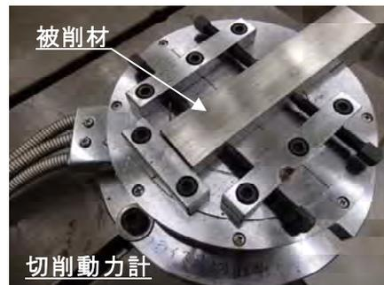
図7 切削動力計に取り付けた被削材
