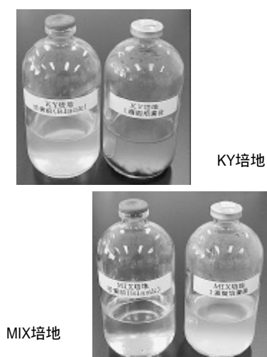
図1 PCE含有培地による分解微生物群の培養
