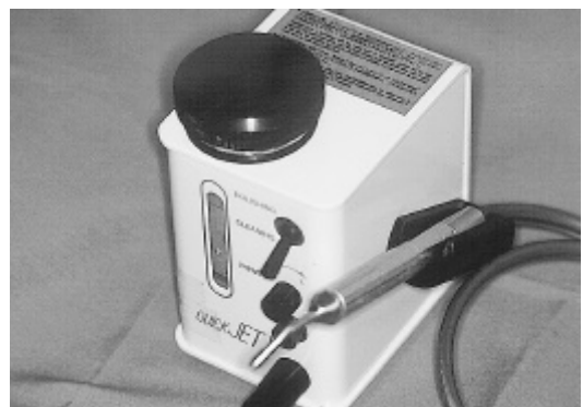
図6 噴射洗浄（Air Polishing）装置
