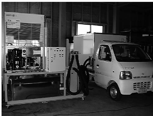
図3 試作した低温配送システム
