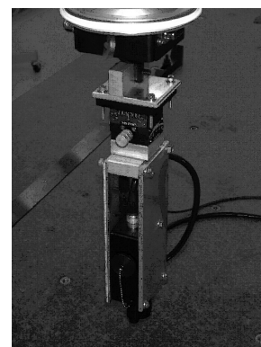
図1 変位計の装着状態
