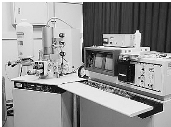
図4 観察手法4 (株日立製作所製電界放出形走査電子顕微鏡)
