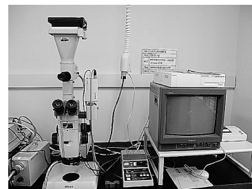
図1 観察手法1 (株ニコン製システム実体顕微鏡)
