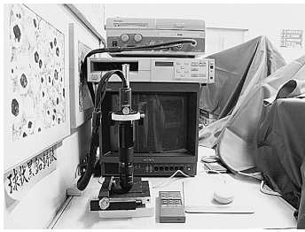
図3 観察手法3 (株KEYENCE製デジタルマイクロスコープ)
