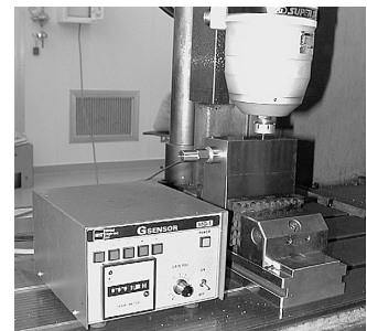
図3 振れ測定状況
