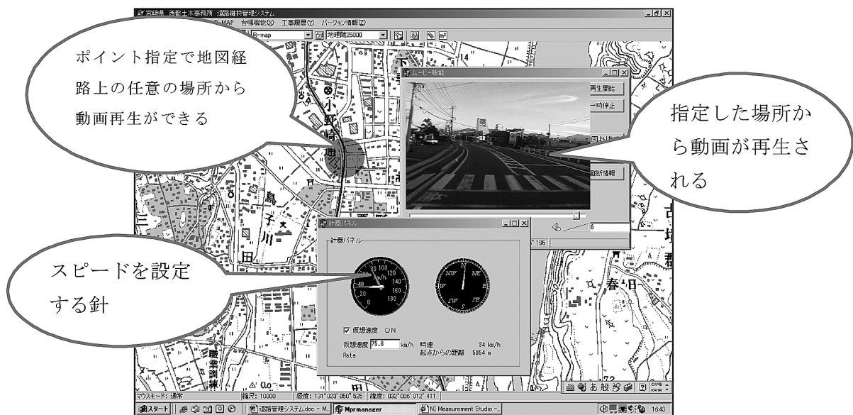
図1 完成した道路保全管理システム
