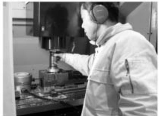
図5 音響センサによる高さ位置決め
