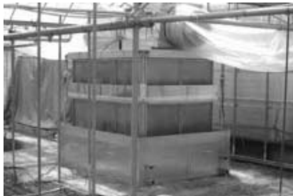
図3 流下液膜方式の除湿装置
