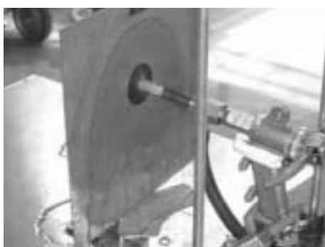
図3 水を用いたエアブラストの実験
