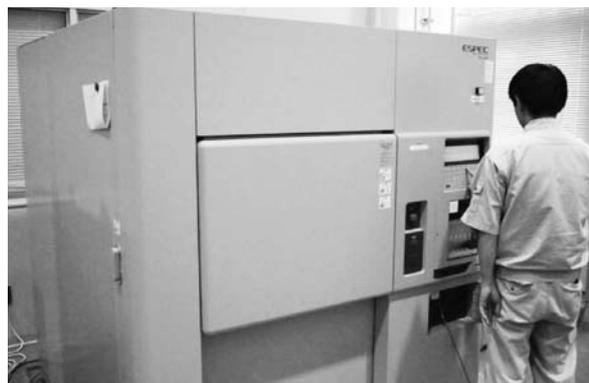
図1 冷熱衝撃試験機
