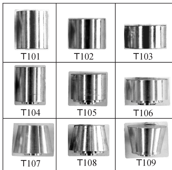
図3 試験片（スラグ）の形状
