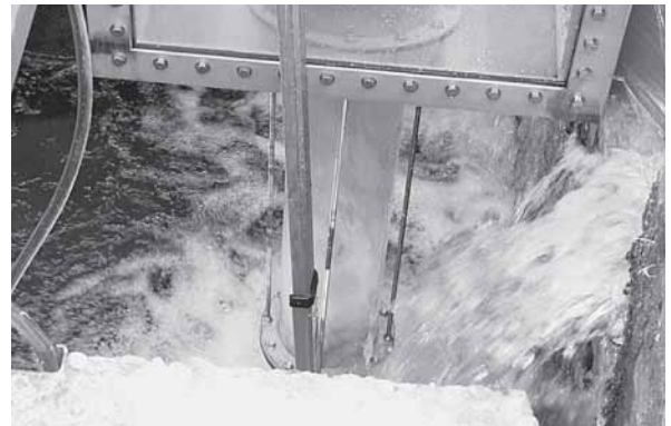
図16 渦巻きケーシングと「水没した逆さまキャップ」を組み合わせた場合の実験
