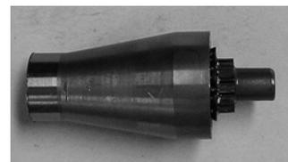
図9 小ギア部分の成形実験結果
