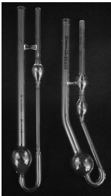
図1 毛細管粘度計の写真 右はキャノンフェンスケ、左はオストワルド。
