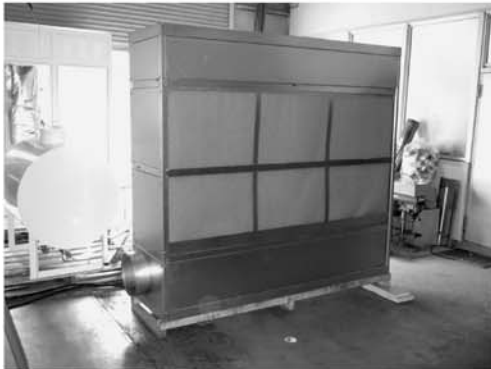
図1 工場内性能実験中の除湿ユニット
