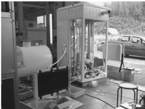
図2 工場内性能実験中の再生ユニット
