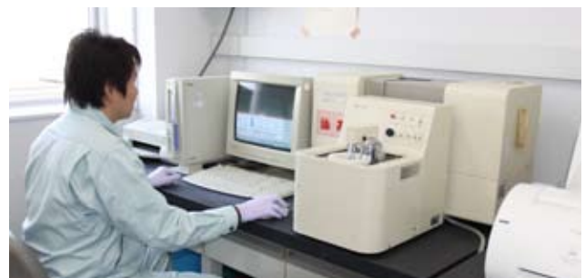
ミクロンからナノオーダーまで測れるレーザー回折散乱式粒度分布計
