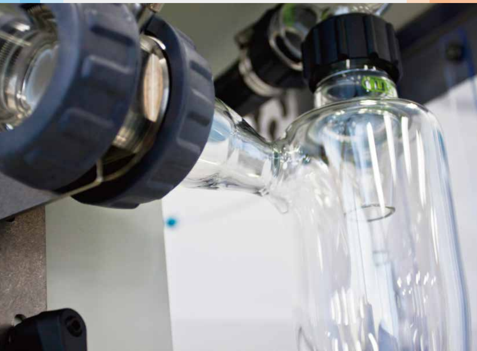
上の写真は、小型スプレードライヤーの液体が粉体にかわるガラスシリンダー部です。
