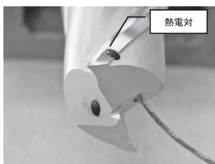
図2 熱電対埋め込みエンドミル
