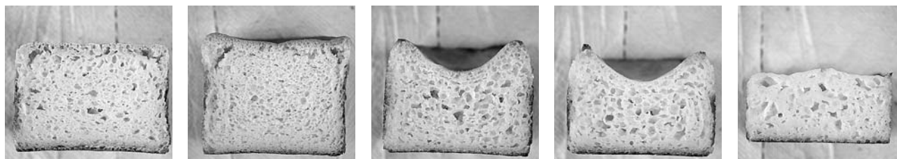
図2 パンの断面形状（左より加水量75%，80%，85%，90%，100%）
