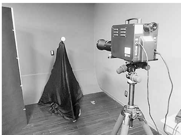
図2 PPFD測定状況（電球型器具）
