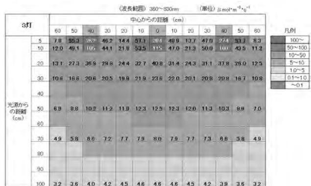
図 4 光量子束密度分布（器具 3 個/区）
