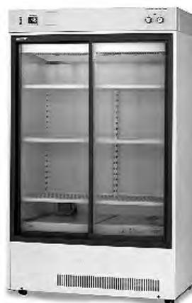
図6 農産物の鮮度保持実験に用いた市販恒温器 (相対湿度の調節機能はない)
