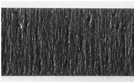
図 4 加工 2 (# 80 ガーネット, 330mm/min)
