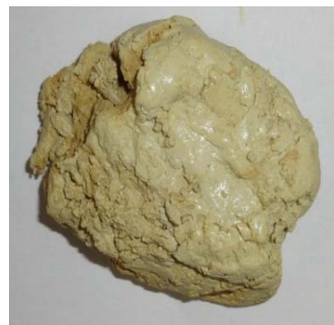
図4 回収したSn(OH) 2 のスラッジ
