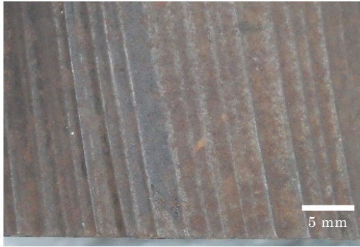
図 4 銅材部を加工したときに発生したスジ
