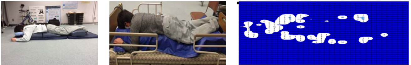
図 11 試作マット（顔・胸・骨盤・膝の支持）の外観，腹臥位姿勢と体圧分布状況
