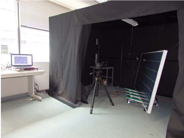
図 11 EL 測定設備 （（株）アイテス，PVX-300 システム）
