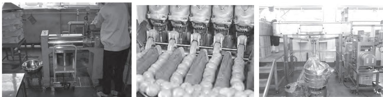
図1 搾汁機（左から、パルパー式，インライン式，ベルト式）
