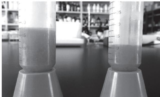
図 1 酵素処理試験における固形物量の変化
