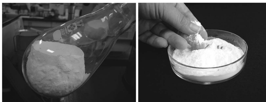
図8 得られたサブミクロン球状単分散シリカゲル粒子
