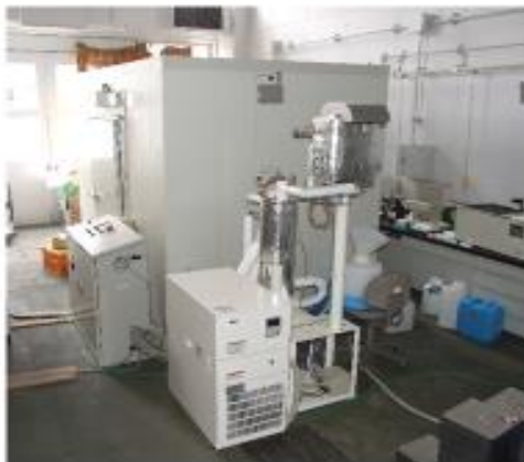
低温調湿装置を組み込んだ鮮度保持貯蔵庫
