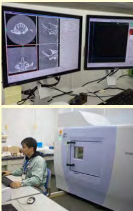
①X線CT装置にて3Dデータ化
