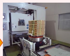
実験室にて輸送試験・評価
