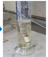
着色排水 (脱色試験後)
