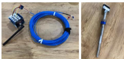
熱電対による計測装置
