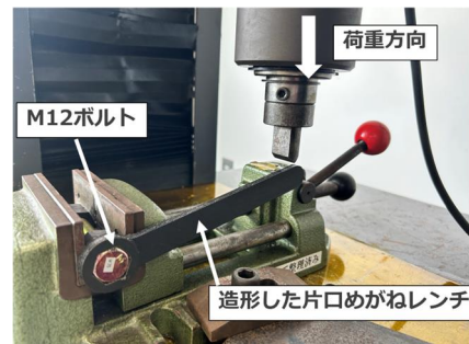
図9 最大締め付けトルク計測状況
