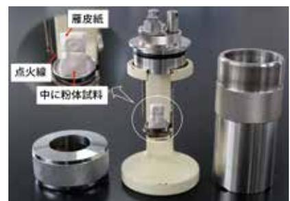
ボンベ及び試料の設置状況 (粉体試料の場合)
