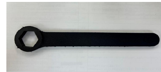
図8 造形した汎用工具のモデル(片口めがねレンチ)
