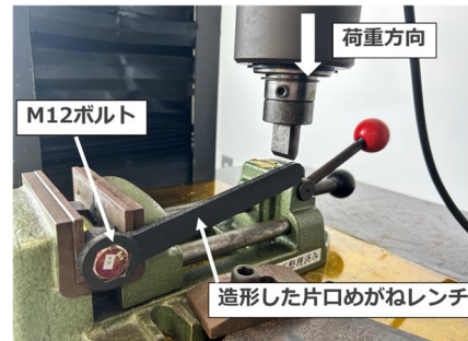
図9 最大締め付けトルク計測状況
