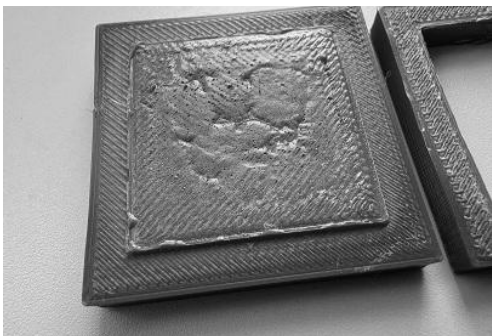
図 10 溶損した樹脂製鋳型
